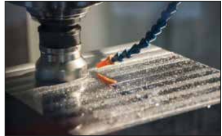
Fresatura ad alti avanzamenti
