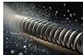
Operazione di sabbiatura con sfere di vetro (pallinatura)
