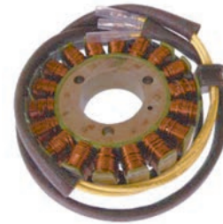
16.3049 statore 18 poli trifase - s/pick-up - 103x38x20
