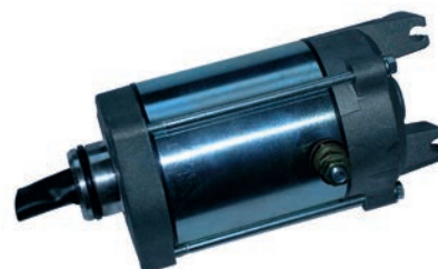
17.81102 motorino 12V - 21 denti - Ø 11,4 - rotazione dx
