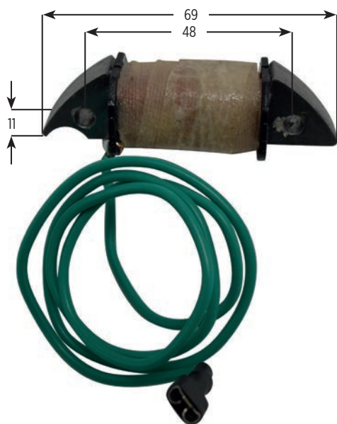
00.1076 impianto Ducati Energia - c/cavo 55 cm
