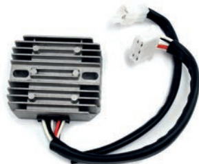
17.2412 regolatore DZE 12V - trifase - c.c. - 7 cavi - 2 connettori (3 bianchi/alternatore - 1 nero/massa - 1 rosso/batteria - 1 marrone/ sensore chiave - 1 verde/interruttore campo alternatore)
